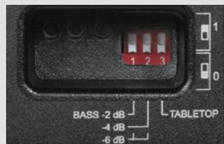
「TABLETOP」をオンにすると、低音成分を-4dB抑制。机面への反射の影響も抑えられる。
