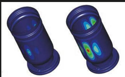
「SSB-380S」は、ステンレスの2重構造にして内筒と外筒との間を真空にした「真空エンクロージャー」を採用。コンパクトでありながら高い剛性と制振性を持つのが特長だ。写真は、真空状態(左)と非真空状態(右)の一定荷重を加えたときの様子。青部分が多い方が剛性を高いことを示している。
