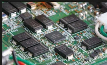
ハイレゾ再生するため、DACにはAKM「VERITA AK4490EN」を採用。PCM768kHz/32bit、DSD11.2MHzまで対応する。スピーカー駆動用のアンプ回路には厳選したオーディオグレードの部品を搭載。専用のディスクリート構成で組み上げたヘッドホンアンプも、VECLOSが目指す高忠実度再生の礎となっている。
