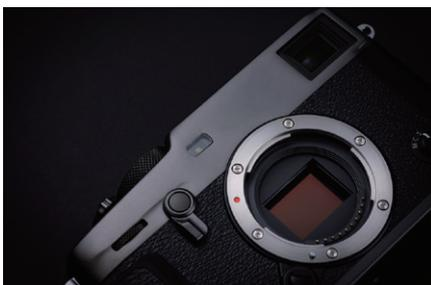
軽量、高強度かつ耐久性に優れたチタンをボディ外装に使用し、さらにその外装の美しさをより際立たせる「デュラテクト」加工を施すなど、外装の質感をとことん追求。従来にない新たな取り組みとして高く評価します。
