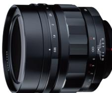
**SPEC** ●焦点距離: 60mm ●絞り値: f/0.95-f/16 ●最短撮影距離: 0.34m ●フィルター径: φ77mm ●外形寸法: 最大径φ82.5mm×全長87.7mm ●質量: 860g ●対応フォーマット: マイクロフォーサーズ ●対応マウント: マイクロフォーサーズ
